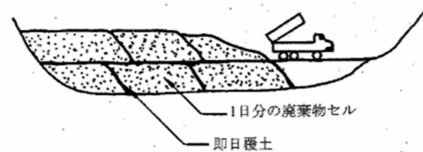
図 7 セル方式による埋立方式
