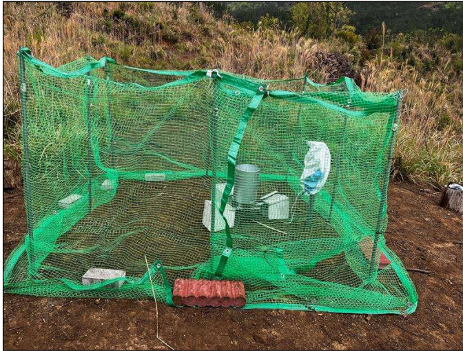
写真2 気象調査状況（周囲のネットは鳥獣からの保護用に設置）
