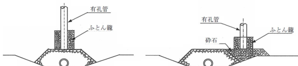
図 10.4.7 豎型集排水管の構造例
