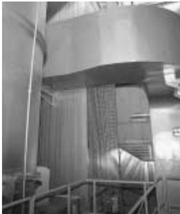
バグフィルタ 排ガスに含まれた飛灰などを何層もの構造で取り除きます。
